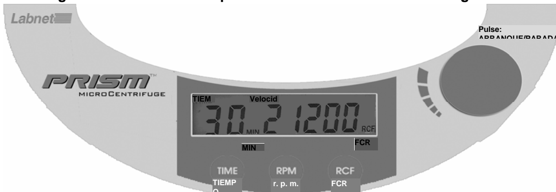
Figura 2. Distribución del panel de control de la Microcentrífuga Prism
