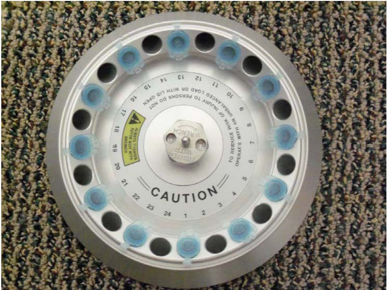
Figura 1. Carga del rotor para conseguir equilibrio
