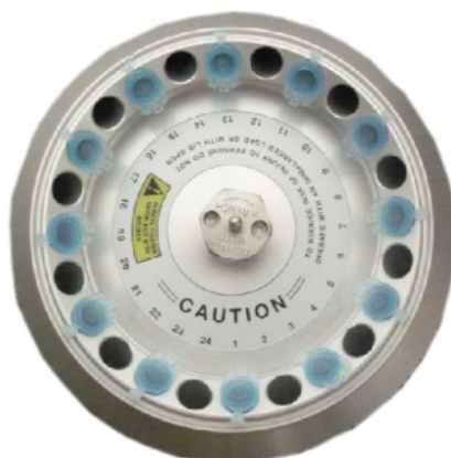
Figura 1. Carregar o rotor de forma a obter equilíbrio
