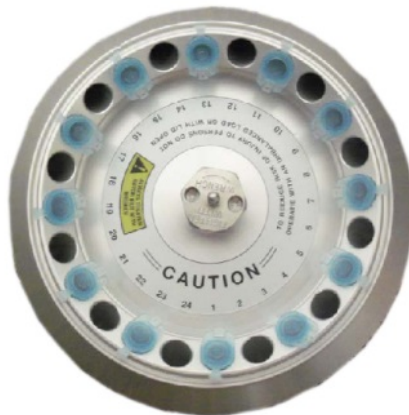
Figura 1. Caricare il rotore per raggiungere il bilanciamento
