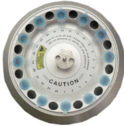
Figure 1. Chargement du rotor pour atteindre l'équilibre
