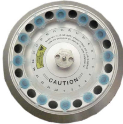
Figura 1. Carga del rotor para conseguir equilibrio
